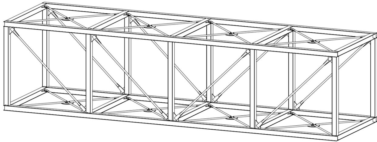
**Schematische Axonometrie Passerelle**
